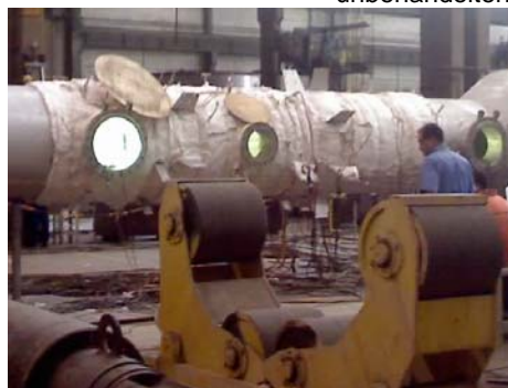
Härtung mit Hilfe von umwickelten Heizelementen
